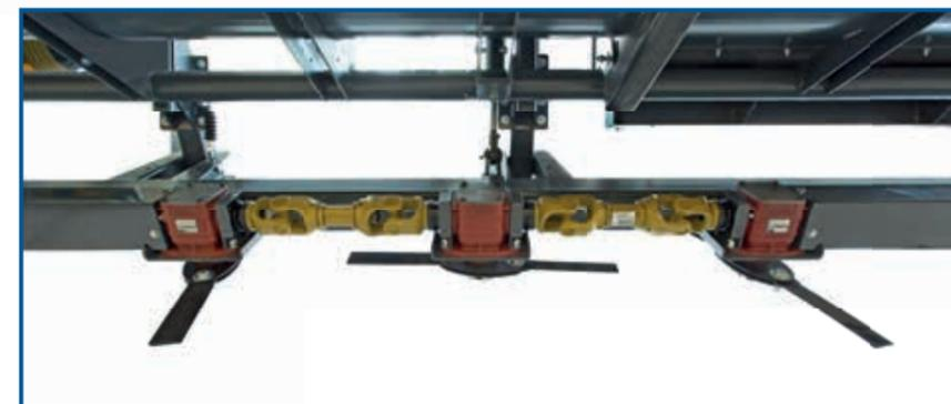
Можно оборудовать безрядную подсолнечную жатку с измельчителем с механическим приводом. Ножи режущей системой работают на всю ширину уборки. С комбайна можно гидравлическим видом регулировать высоту режущей системой.
