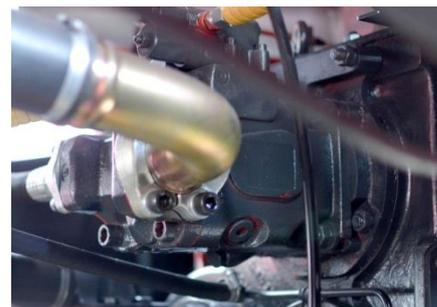
Аксиально-поршневой насос Bosch-Rexroth приводится от редуктора привода насосов (РПН). Подача насоса регулируется в автоматическом режиме, максимальная производительность составляет 180 л/мин.
