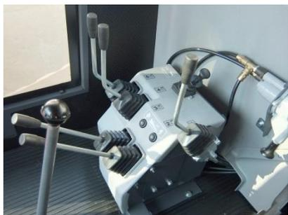
Дистанционное управление гидрораспределителем производится через тросовый привод механическими рычагами. Регулировка потока на секциях осуществляется рукоятками, расположенными позади сиденья водителя.
