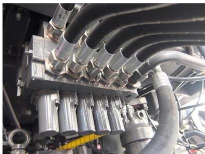
5-секционный гидрораспределитель Bosch-Rexroth расположен под кабиной. Одна секция управляет работой навески (при установке опции EHR заменяется на электрогидроуправляемую).
