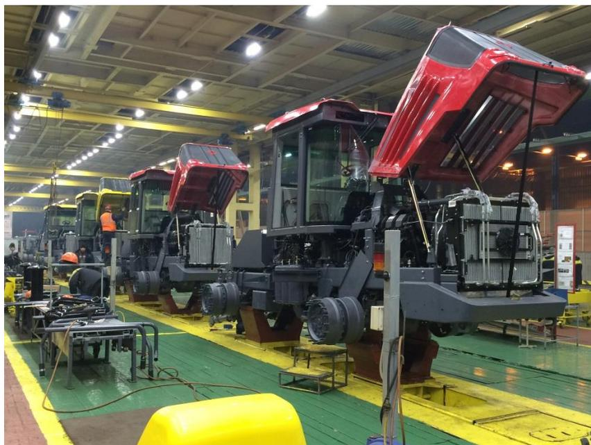
В январе 2016 года Петербургский тракторный завод начал выпуск тракторов «Кировец» серии К-744Р с новой кабиной. Основной целью очередного этапа модернизации нашего трактора стало улучшение условий работы механизатора.
