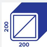
**Рама из бруса 200×200×10 мм** обеспечивает жесткость конструкции, исключает изгибание и деформацию при нагрузках;
