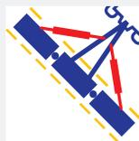
**Равномерное заглубление:** крылья всегда параллельны благодаря опорно-рычажной системе фиксации крыльев.
