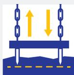
Регулировка соединительными цепями дает **одинаковую глубину обработки** передними и задними зубьями;
