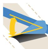
**Регулируемая ширина захвата каждого корпуса.** Ступенчато изменяемая ширина захвата (35, 40, 45 см)
