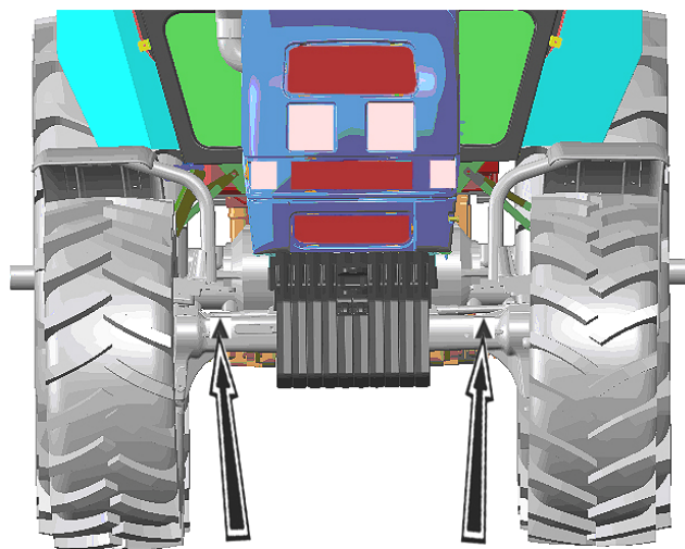
Рисунок 5.6.3 – Схема установки домкратов при подъеме передней части трактора
